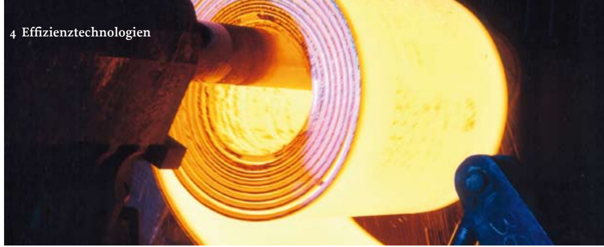
Um Temperaturverluste zu vermeiden, wird das Stahlband vor der Fertigungsstraße aufgespelt.
